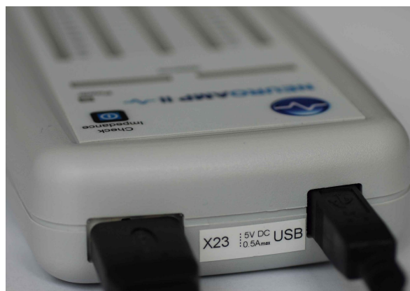
Abbildung 5a: USB-Anschluss des Verbindungskabels zum EEG NeuroAmp II.5s und x23/x39-Anschluss für Zubehör. Hinweis: Der x23/x39-Anschluss ist nur verfügbar bei dem EEG NeuroAmp II.5s (A001001) mit grauem Gehäuse.
